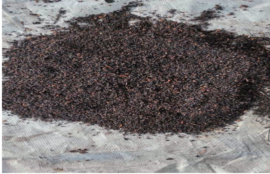
▲ 가수열분해 건조기 처리 전·후 축분 슬러지 비교. 투입 전 대비 악취는 95% 저감되고, 함수율은 85%에서 20% 미만으로 낮아진 상태로 배출된다
