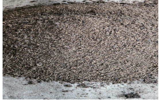
▲ 가수열분해 건조기 처리 전·후 축분 슬러지 비교. 투입 전 대비 악취는 95% 저감되고, 함수율은 85%에서 20% 미만으로 낮아진 상태로 배출된다
