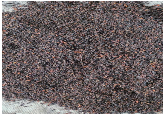
▲ 가수열분해 건조기를 통한 음식물 처리 전·후 비교. 함유율 85%에서 20% 미만으로 감량된 모습
