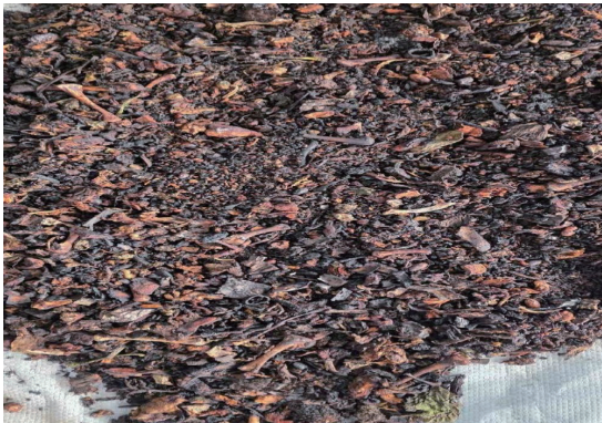
▲ 가수열분해 건조기를 통한 음식물 처리 전·후 비교. 함유율 85%에서 20% 미만으로 감량된 모습
